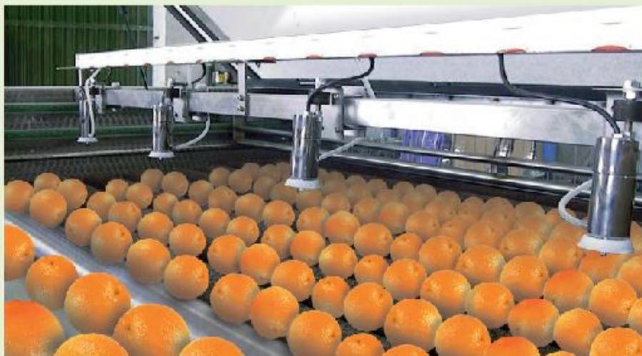
Les pulvérisateurs fins MAFEX Potato & MAFEX Fruit peuvent être équipés avec jusqu'à quatre buses rotatives spécialement développées. L'illustration présente une possibilité d'utilisation sur une table de tri pour fruits.
