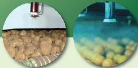
Le pulvérisateur fin MAFEX Potato & Fruit utilise la technique ULV (Ultra Low Volume) permettant de nettement réduire les quantité épandue grâce à une répartition optimale des agents actifs et des gouttelettes de taille régulière. Celui-ci est utilisé depuis plusieurs années, tout particulièrement pour une protection optimale des récoltes de pommes de terre - avec des inhibiteurs de germination et des fongicides -, mais aussi de fruits - avec de la cire et des fongicides.
